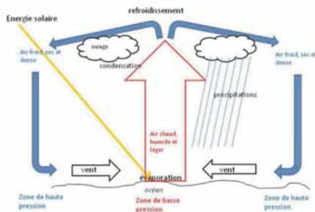
ou gazeux) chauffé se dilate proportionnellement à l'augmentation de sa température. Donc, l'air en A se dilate plus que l'air dans la zone environnante. Plus l'air est dilaté moins il est dense.
